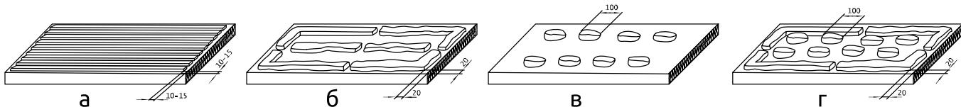
Рис. 4. Способи кріплення теплоізоляційних плит
