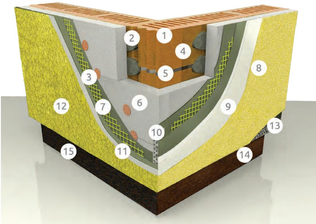
Рис. 3б. Схема розміщення складових конструкції стін із фасадною теплоізоляцією та опорядженням штукатуркою
