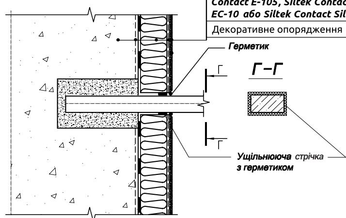
Примикання конструкції фасадної теплоізоляції
