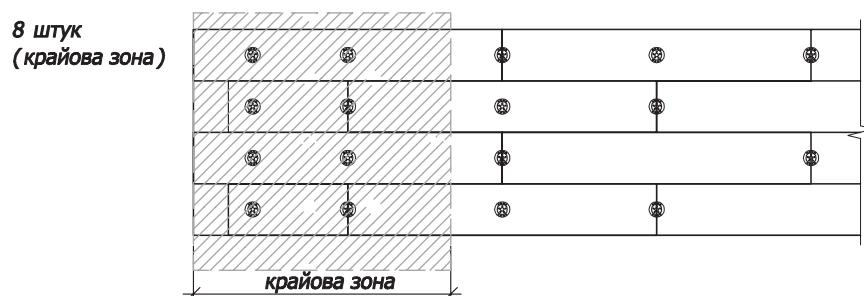
Рис. 2б. Схема розміщення дюбелів. Розмір плити: 1200x150 мм, 1200x200 мм.
