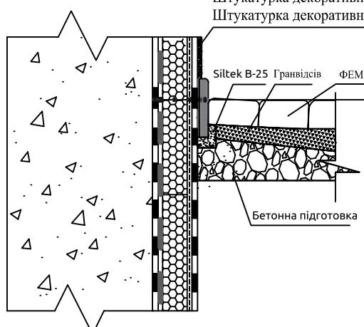
Гідроізоляція Siltek V-30
