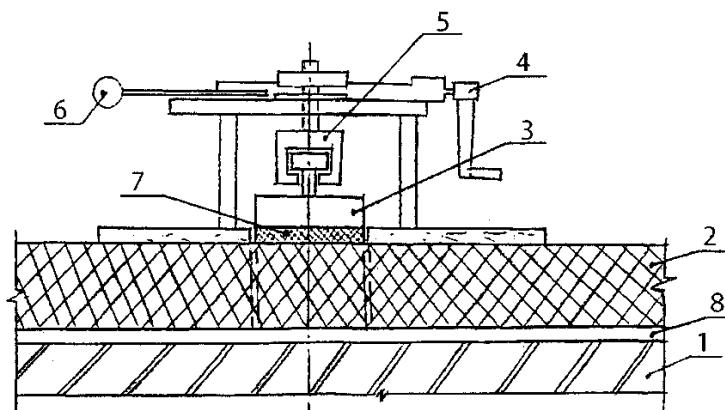
1 – основа; 2 – система утеплювача; 3 – відривний елемент; 4 – елемент навантаження;
