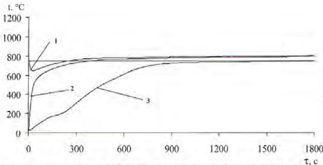
Рисунок 1 – Графік змінення температури у печі (1), на поверхні (2) та всередині (3) зразка № 3 під час випробувань
