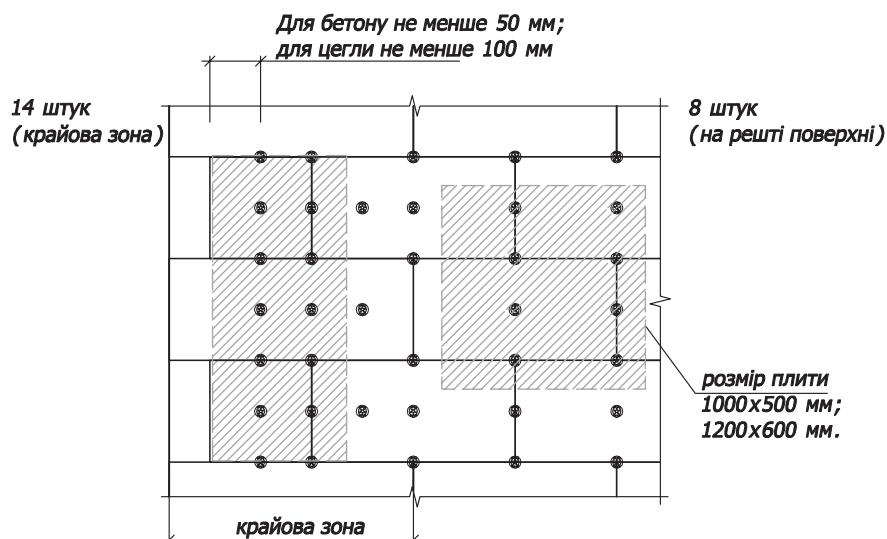
Рис. 2с. Схема розміщення дюбелів.
